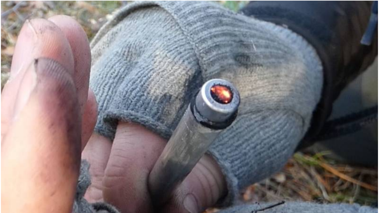
Feuerpumpe mit Glut
