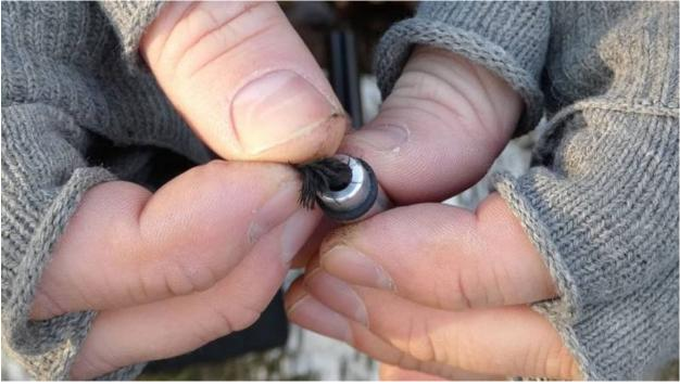
Setze den Zunder in die Vertiefung des Kolbens
