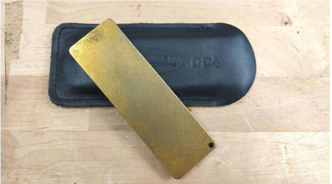
Ein kleiner Taschenschleifstein mit Diamant auf einer Seite (sichtbar) und Keramik auf der anderen Seite um dein Messer im Feld scharf zu halten
