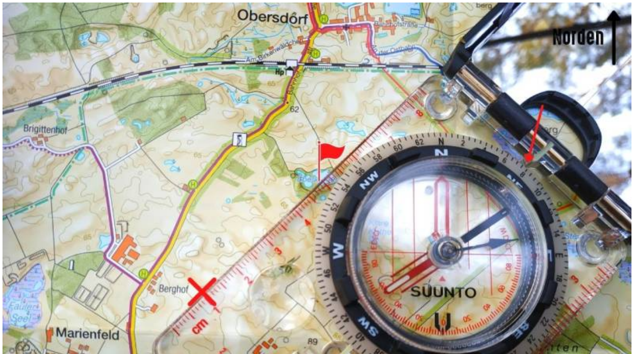
Schritt 4: Lese die Marschkompasszahl ab und merke sie dir
