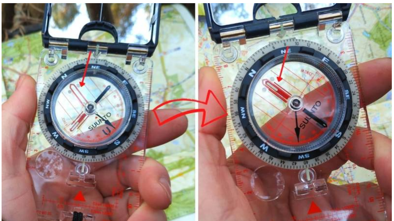
Schritt 5: Drehe dich nun so lange auf der Stelle, bis Nadelnord und Dosenord übereinstimmen
