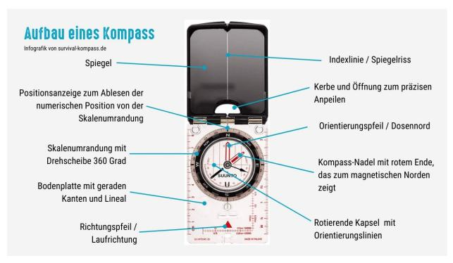
Aufbau eines modernen Kompasses
