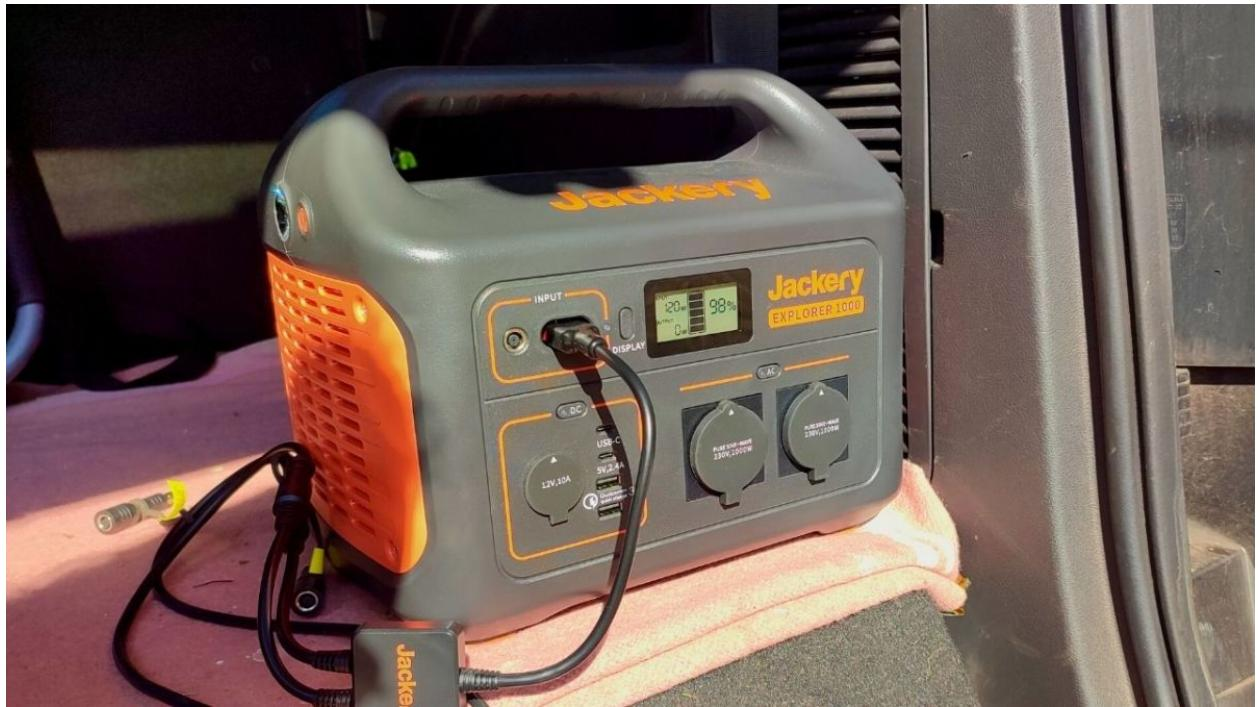
Jackery empfiehlt, dass du die Jackery Explorer 1000 nicht unter 20 % Akku fallen lässt. Das ist ganz normal für jede Batterie dieses Typs. Wenn die Kapazität auf dieses Niveau abfällt, blinkt das LCD, um dich darauf hinzuweisen, dass du die Powerstation aufladen solltest.
