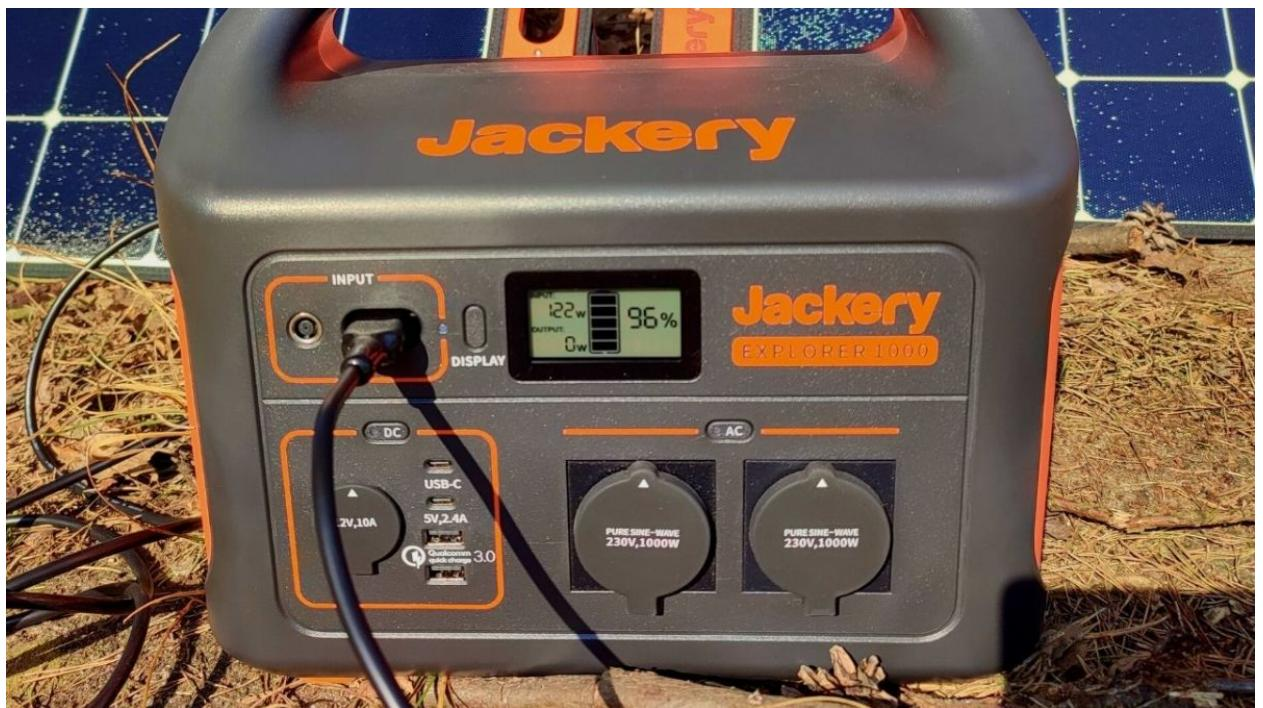
Aber was die Jackery Explorer 1000 so interessant macht, ist, dass sie nicht nur über das Stromnetz aufgeladen wird, sondern auch über Solarpanels.
