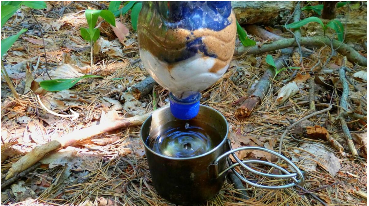
Ein selbstgebauter Wasserfilter für eine Überlebenssituation
