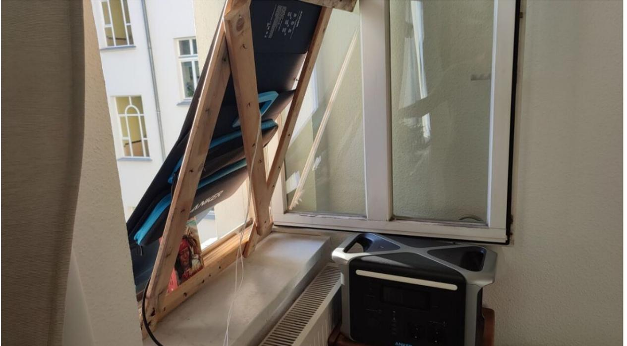
Am Fenster kann ich die Anker PowerHouse 757 über das Anker 625 Solarpanel aufladen
