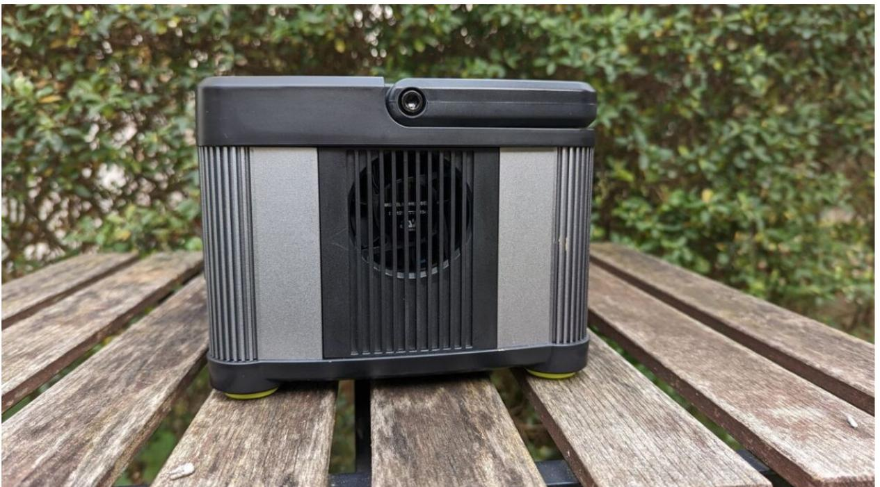
Links und rechts an der Powerstation befinden sich Lüfter, die jedoch nur bei starker Leistungsentnahme anspringen.
