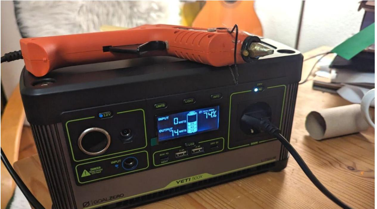
Ein Test mit einer Heißklebepistole lässt den Lüfter kurz hochfahren
