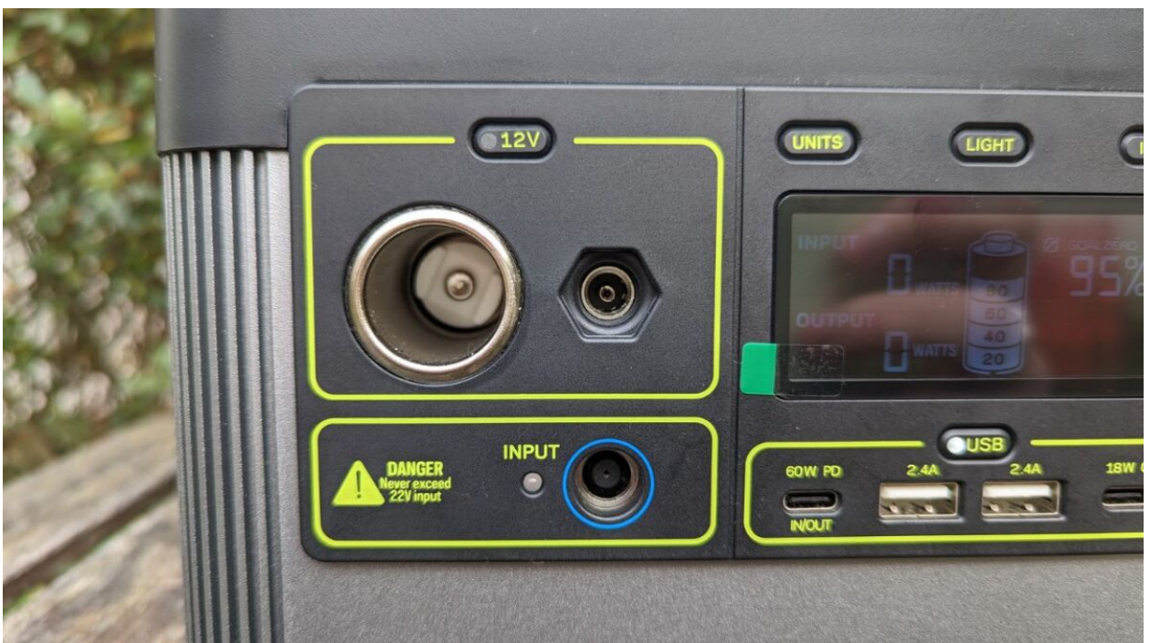
Die Goal Zero Yeti 500x kannst du über Steckdose, Solarpanel, USB-C oder Autoladekabel aufladen
