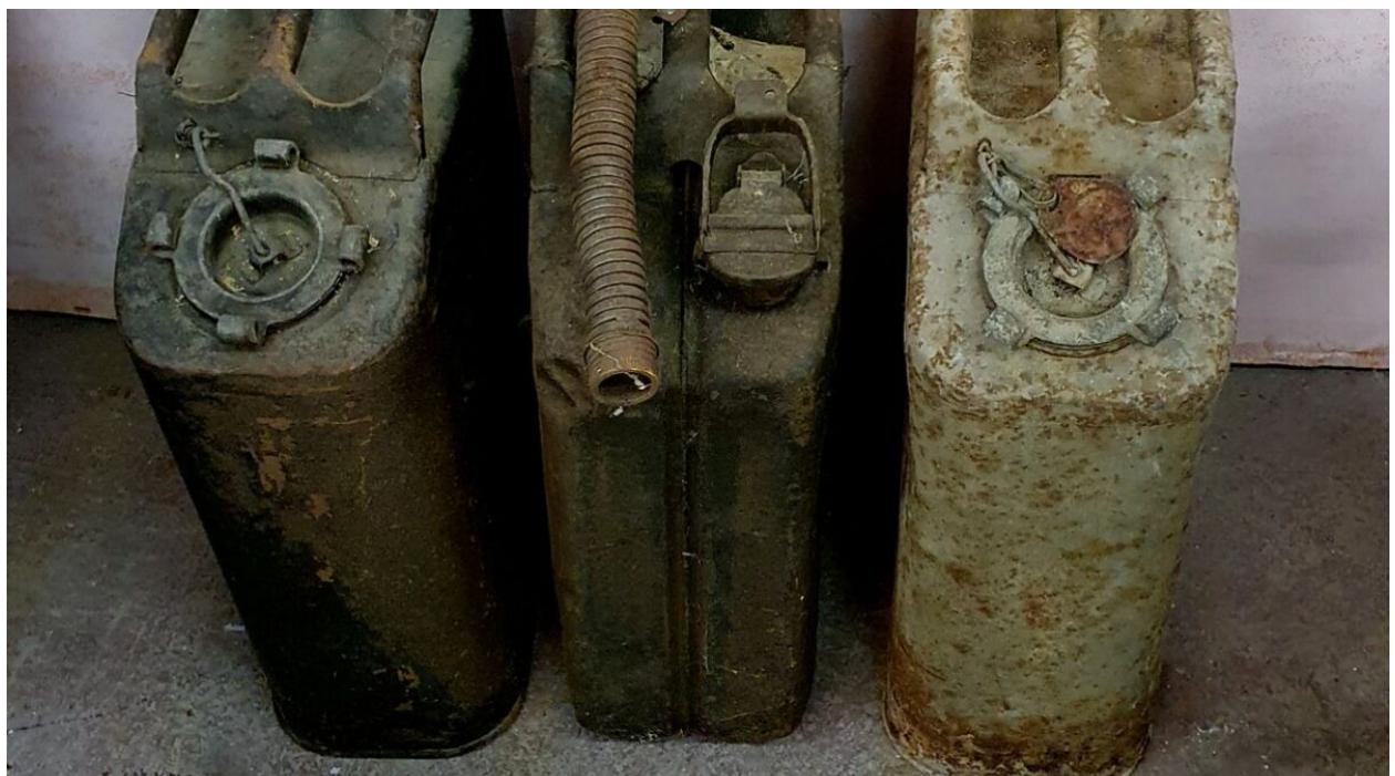
Ethanol zieht Wasser an, daher kann bei einer langfristigem Lagerung ein Benzinkanister aus Metall anfangen zu rosten
