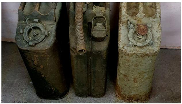
Ethanol zieht Wasser an, daher kann bei einer langfristigem Lagerung ein Benzinkanister aus Metall anfangen zu rosten
