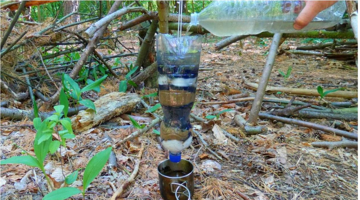
Ein Sedimentfilter ist ein Gerät, das verwendet wird, um Schmutz und andere feste Partikel aus Wasser zu entfernen.
