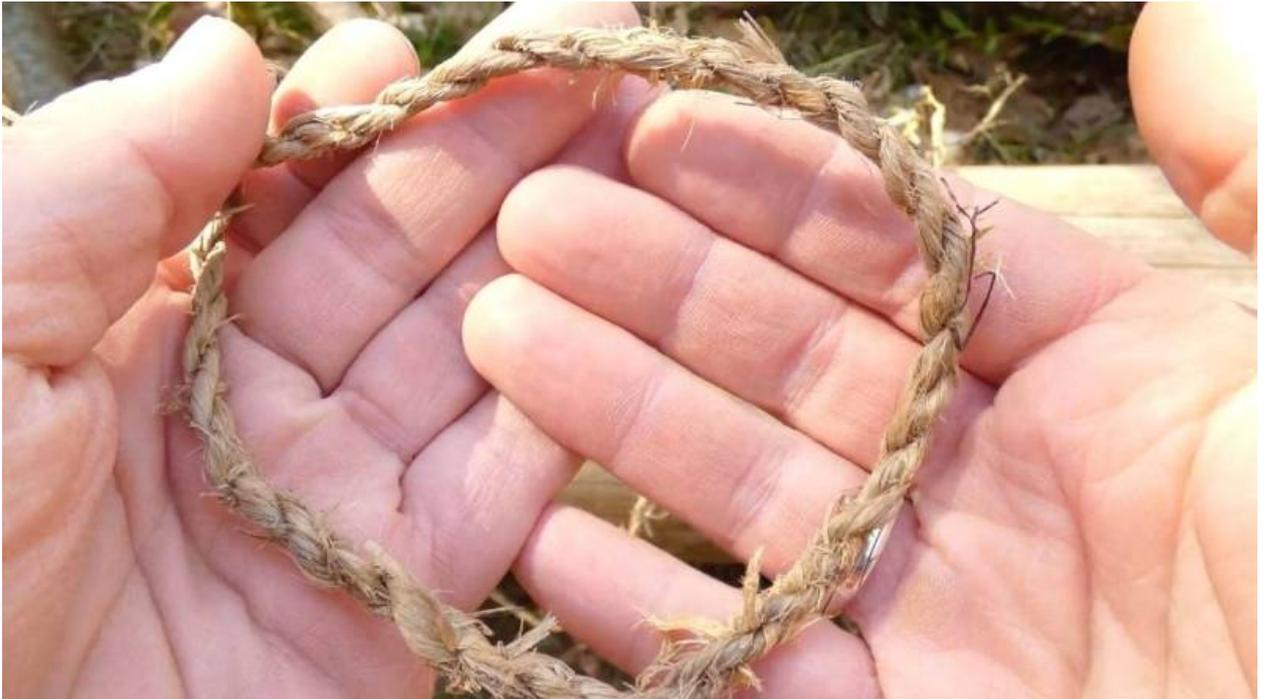
Ein selbstgedrehtes Seil ist ein Seil, das von Hand aus Naturmaterialien wie Hanf, Sisal oder Baumwolle hergestellt wird. Es wird durch das Zusammenführen von einzelnen Fasern oder Fäden zu einem stabileren Strang und anschließendes Verdrehen des Strangs erstellt.
