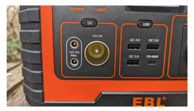
Besitzt du etwa ein MacBook Pro von Apple, dann lade dies unbedingt mit dem USB-C-Anschluss und nicht über den Netzstecker. Dadurch sparst du Strom, weil der Wechselrichter nicht aktiv ist.
