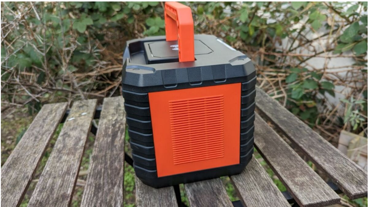
An der Seite sind die Lüfter angebracht
