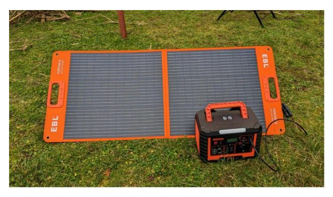
Beim Verwenden des mitgelieferten Wandstecker-Netzteil lädt die Voyager 500 mit über 100W und dauerte in meinem Test 6,5 Stunden von 0 auf 100 %.
