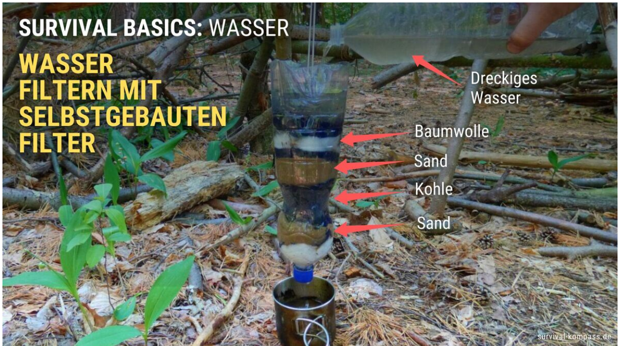
Wasser filtern mit selbstgebauten Wasserfilter
