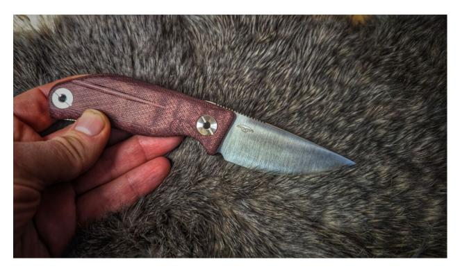
Die Konvexschneide des Messers macht es sehr scharf und ermöglicht es, präzise und kontrollierte Schnitte auszuführen.
