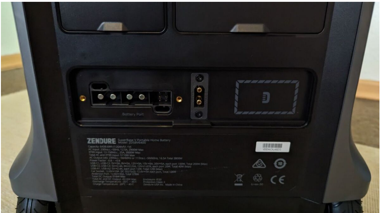
Die Rückseite mit dem Anschluss für die Satellitenbatterie
