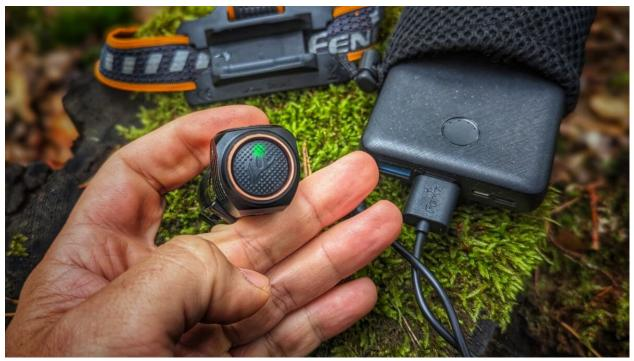
Ist die Lampe voll aufgeladen, siehst du das, in dem du kurz auf den An-Aus-Schalter drückst - grünes Licht bedeutet: alles voll
