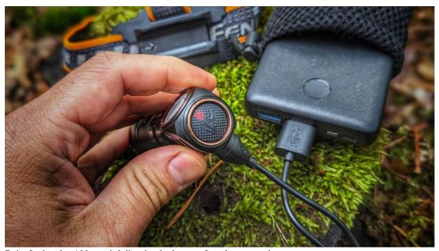
Beim Laden des Akkus wird dies durch eine rote Leuchte angezeigt
