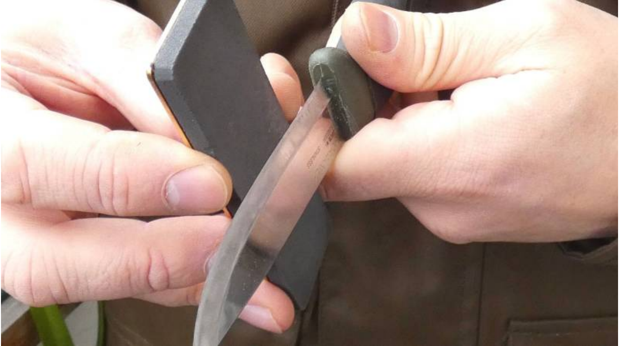
Messer wird auf einem Schleifstein geschärft
