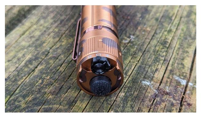
Wie du oben auf dem Bild sehen kannst, gibt es eine Schalter/Rädchen und einen Knopf. Dieses System nennt Fenix das "FlexiSensa Control" - es lässt sich schnell mit einer Hand bedienen.
