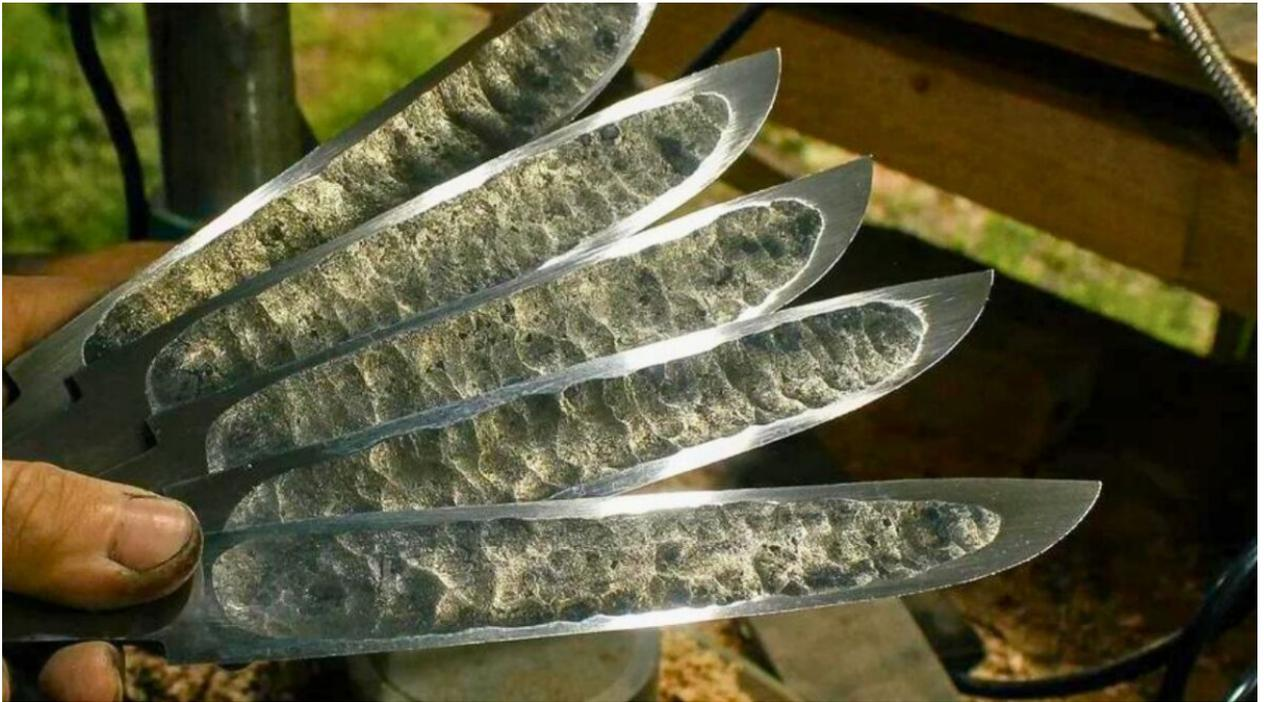
Die Konstruktion der Klinge und ihr Profil sorgen für ausreichende Festigkeit, auch wenn ein dünnerer Stahl bei der Herstellung verwendet wird, was bedeutet, dass für die gleiche Größe 1/3 weniger Material als bei einer herkömmlichen Klinge benötigt wird.
