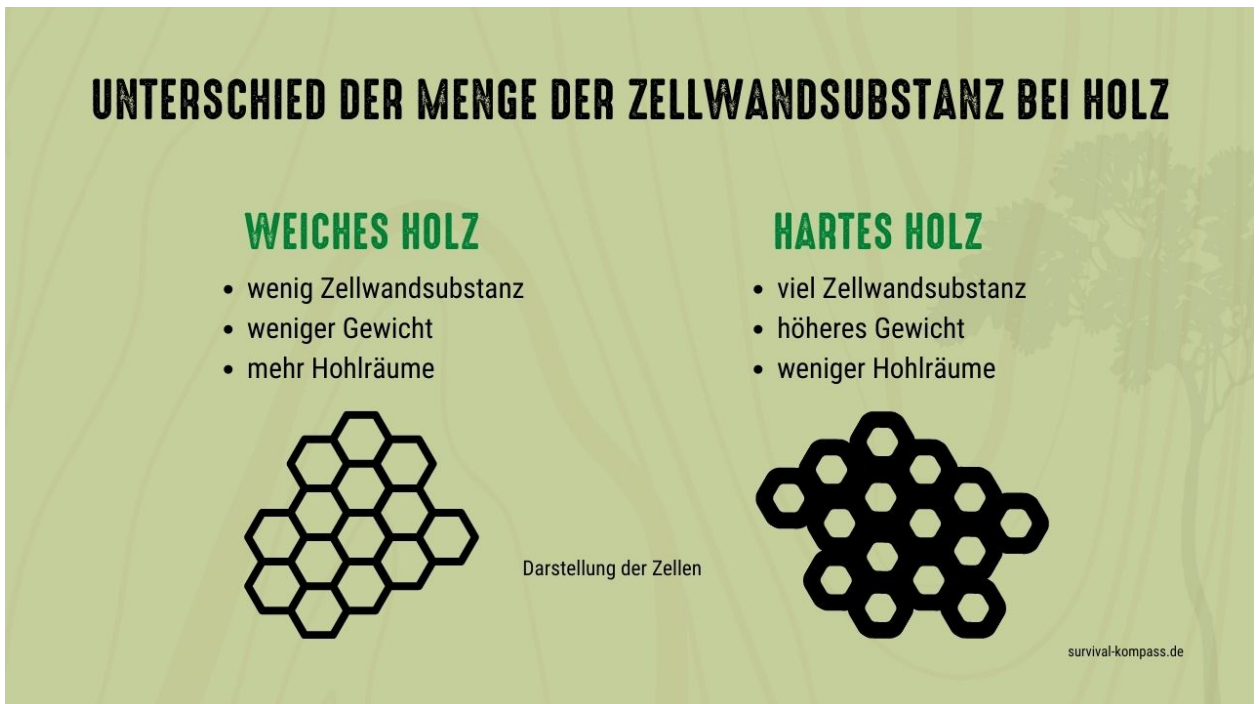
Unterschied der Menge der Zellwandstruktur bei Holz
