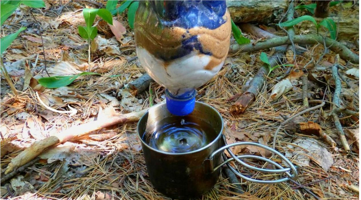
Der Survival-Wasserfilter – unten in der Flasche siehst du die Zellulose, eine Stoffschicht und Sand
