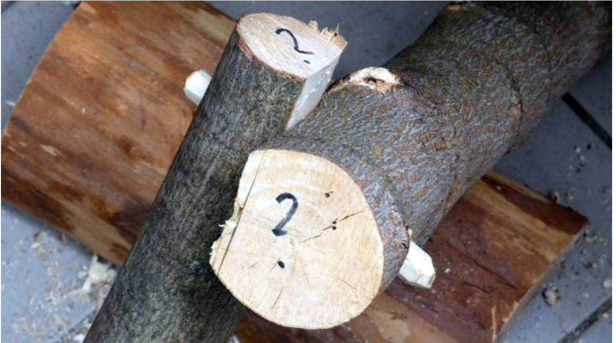
Eine einfache Zapfenverbindung, gebohrt mit dem Schlangenbohrer
