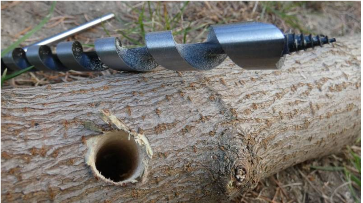
Mit dem Bushcraft Bohrer bohrst du mit der Hand Löcher
