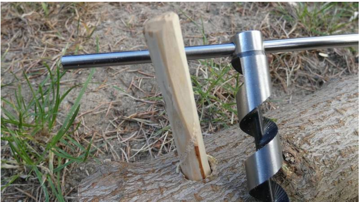
Ein geschnittener Zapfen, welcher in das Loch vom Bohrer gesteckt wird
